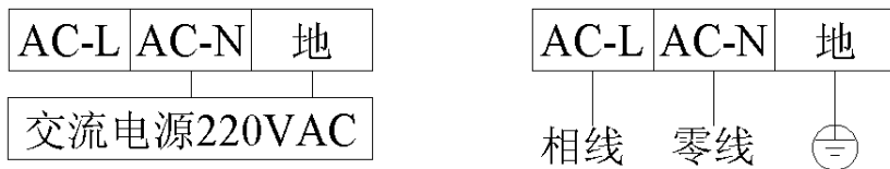
图 3 交流电源 220VAC 输入接线图
