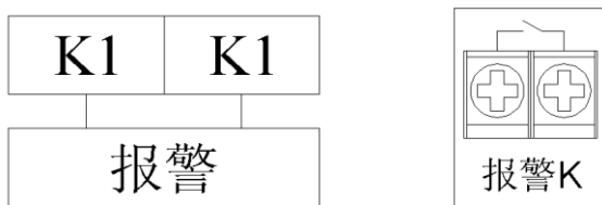
图 5 继电器触点输出接线图
